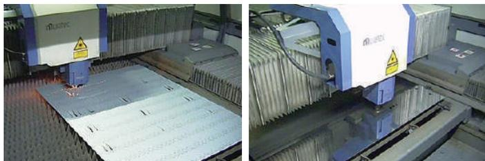
世界最速の分速 340M のファイバーレーザー切断機。
