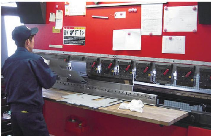
自動曲げ角度補正システム Bi-J 高精度で安定した曲げ加工。
